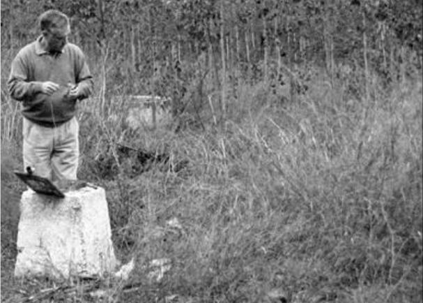
*Uno de los escasísimos piezómetros históricos (de la época FAO, con medidas desde el año 1968) del acuífero de la Vega de Granada. En la imagen Manuel Labrador, técnico ya jubilado de la Confederación Hidrográfica del Guadalquivir, en labores de control con sonda manual hidronivel (abajo)*
