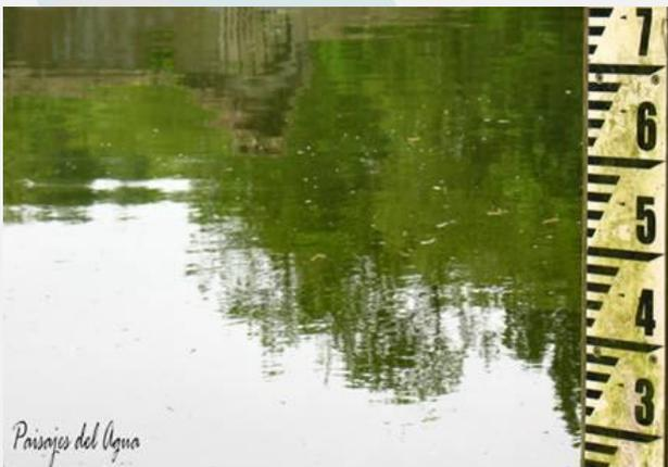
*En ríos, canales y embalses es frecuente ver escalas de este tipo, que miden el nivel de agua, tanto de forma discreta como en continuo a través de sensores automáticos*
