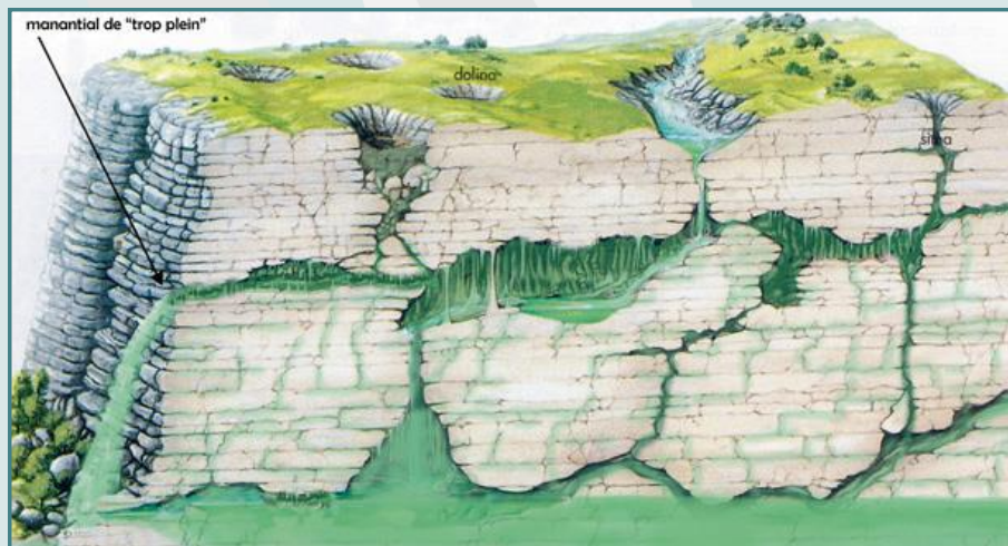
Corte esquemático de un acuífero kárstico, donde se observa el nivel de base con su manantial, con la activación de conductos más elevados que drenan al exterior por otro manantial (de "trop plein") tras intensas precipitaciones (modificado de cosmolinux)
